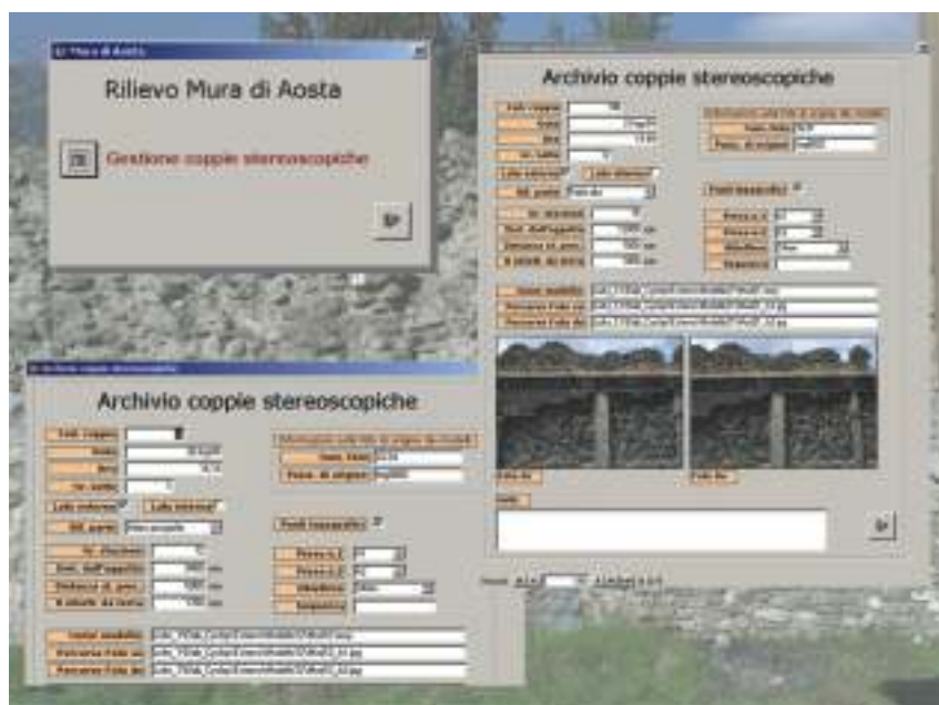
16. Esempio di finestre del database realizzato in MSAccess contenente l'archivio delle immagini fotografiche e tutti i dati identificativi dei singoli modelli.
