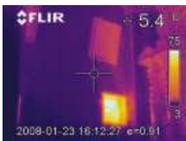
12. Termogramma dopo 30 minuti dall'accensione dell'impianto: le tele e l'altare sono già riscaldati.
